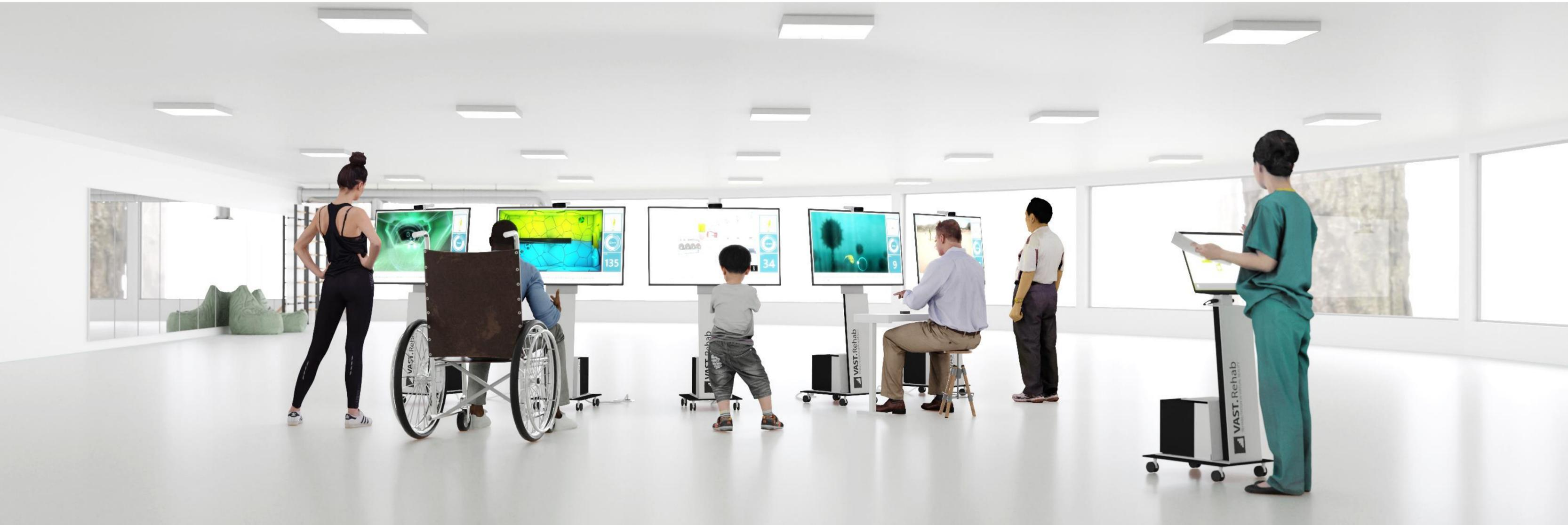
Das System ermöglicht dem Therapeuten mit einem Touchscreen mehrere Einheiten gleichzeitig zu bedienen und überwachen. Es erlaubt die Übungsabfolge zu speichern. Die Übungen wechseln automatisch. Somit ist es nicht notwendig, dass der Therapeut ständig an dem Touchscreen anwesend ist um die Module umzuschalten.
